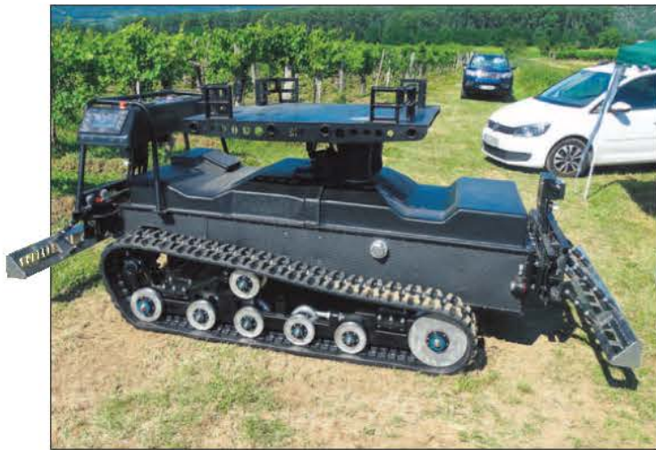
Slovenski Slopehelper je avtonomna izvedba z gosenicami. Tako kot sam traktor so tudi njegovi priključki električno gnani.
