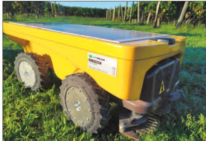
Manjša avtonomna platforma Vitirover iz Francije lahko kosi travo v vinogradih. Poganja ga solarna energija in litij-ionska baterija. Zmore 15 % nagib, pokosi pa do centimetra natančno. V uporabi je že več kot 110 naprav. (Fotografija: Vitirover)
