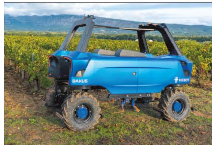
Vitibot Bakus je električni robot za vinogradništvo. Poganja ga baterija z močjo 80 kWh. Razvije hitrost do 6 km/h, dela pa lahko do 12 ur. Ima lahko pasivna orodja ali pa električna orodja (delovne priključke). (Fotografija: Vitibot)
