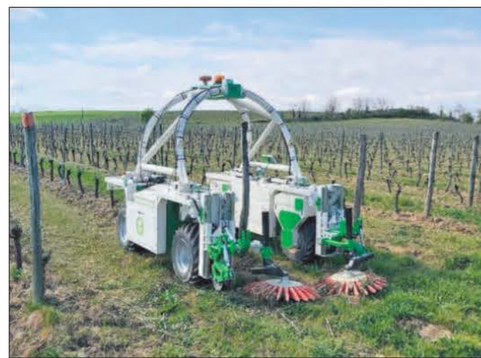
Naïo Technologies ima v uporabi že več kot 150 robotov za različne kmetijske potrebe. TED je vinogradniški model, ki so ga tri leta preizkušali pri 20 vinogradnikih. Namenjen je obdelavi vrstnega prostora v vinogradu. Do sedaj so izdelali 19 enot avtonomnega robota za vinogradništvo. (Fotografija: Naïo Technologies)
