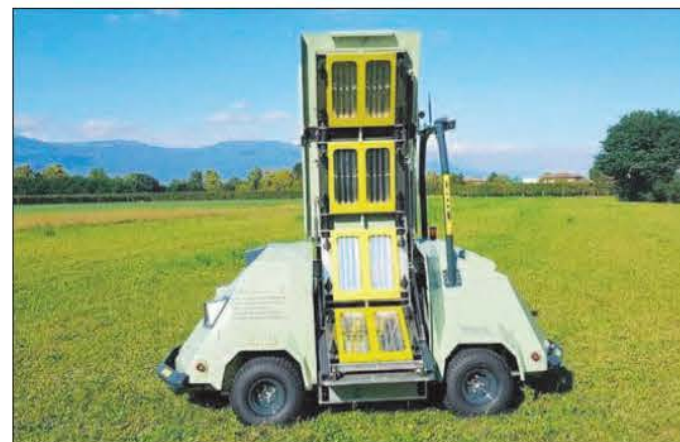
Italijansko zagonsko podjetje Free Green Nature S.R.L. je razvilo Icaro X4, avtonomni robot na motorni dizelski ali bencinski pogon. Namesto pesticidov uporablja ultravijolične žarke za varstvo vinske trte pred peronosporo, oidijem (pepelovko) in botritisom. Torej robot, ki varstvo vinske trte opravlja na okolju prijazen način brez pesticidov.
