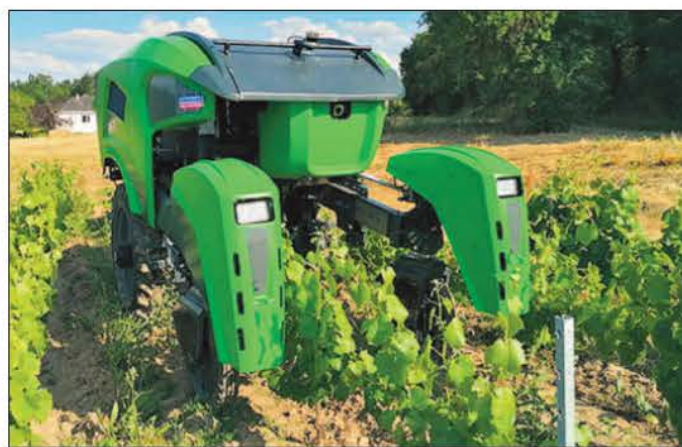
Francoski proizvajalec SITIA ponuja TREKTOR, ki je hibridni (dizel in elektro) avtonomni traktor, namenjen kmetijstvu. Uporaben je tudi v vinogradništvu. Nanj se prek tritočkovnega drogova lahko priključijo različni že obstoječi stroji za vinogradništvo. Vozilo ima variabilno razdaljo med kolesi in variabilno višino. (Fotografija: SITIA)
